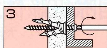
さらにその上から4mm径のビスで締めつけるとアンカーの足が開き固定されます。
