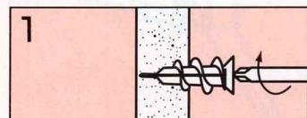
ドライバーを用いて押しながらまわして取付け箇所にねじ込みます。
