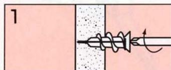
ドライバーを用いて押しながらまわして取付け箇所にねじ込みます。
