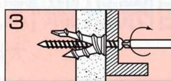
さらにその上から4mm径のビスで締めつけるとアンカーの足が開き固定されます。
